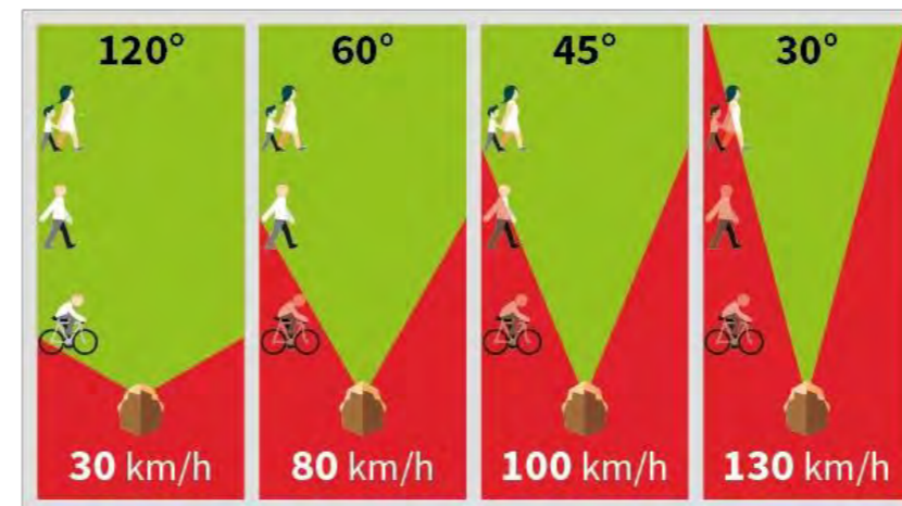
Figure 232 : Réduction du Champ visuel en fonction de la vitesse – source : https://www.ornikar.com/code/cours/conducteur/etat-conduire/champ-visuel
